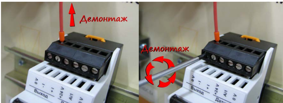
Рисунок 7 – Подключение и отключение внешних устройств к модулям контроллера КАМ200
