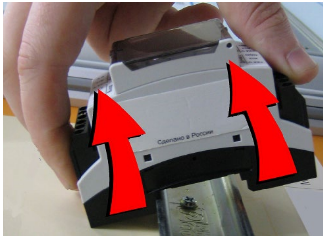
Рисунок 6 – Демонтаж модуля с DIN-рейки
